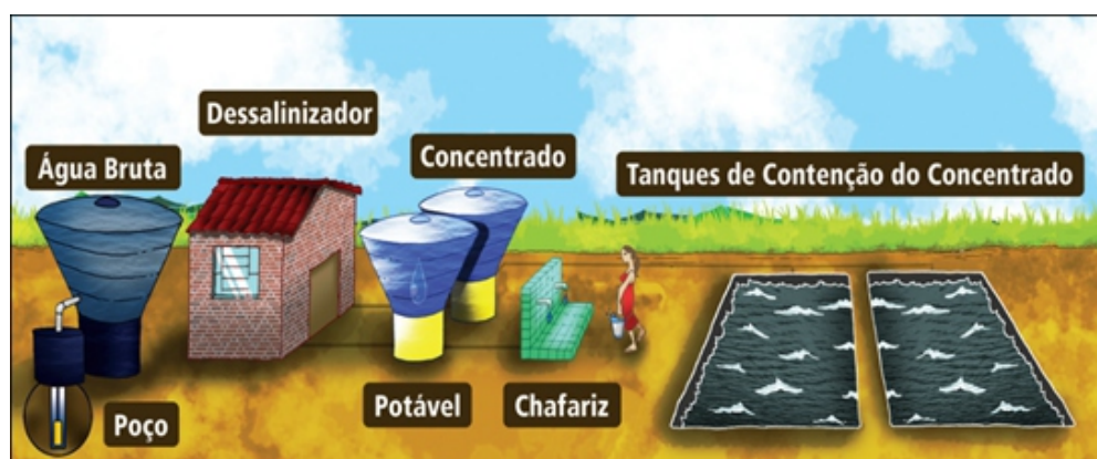
Figura 1 – Modelo de Sistema de Dessalinização do Programa Água Doce
