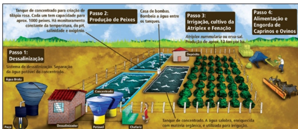
Figura 2 – Modelo de Sistema de Dessalinização do Programa Água Doce com Sistema Produtivo
